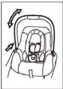
La poignée du siège peut être ajustée en quatre positions fixes. Pour le réglage, appuyez sur le bouton rouge des deux côtés de la poignée.
