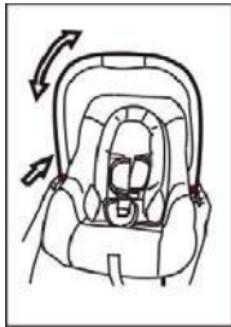
Der Hebel des Sitzes kann in 4 feste Punkte befestigt werden. Für die Regelung drücken Sie die rote Taste auf die beiden Seiten des Hebels.
