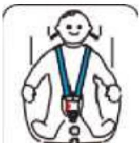
Tirare in su la cinghia di spalla per rimuovere tutta la cintura a bretelle e quindi tirare la cinghia di regolazione finché la cintura a bretelle è completamente stretta (fig. sinistra).
