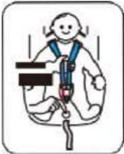
Étape 1: desserrez les sangles en appuyant sur le levier (sous la housse du siège) sur l'avant du siège.
