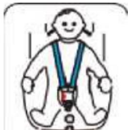
Ziehen Sie den Schultergurt nach oben, um das ganze Geschirr zu entfernen und danach ziehen Sie den Gurtband, bis das Geschirr komplett festgezogen ist (Bild links).
