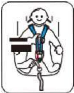
Passo 1: le cinghie sono allentate spingendo la leva (sotto la copertura del sedile) sulla parte anteriore del sedile
