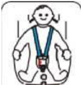
Pociągnij pasy naramienne w góre, a następnie pociągnij pas regulacyjny, aby pasy były dopasowane tak ściśle jak to możliwe (rys. po lewej stronie).
