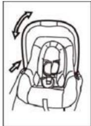
El asa de la silla se puede ajustar en cuatro posiciones fijas. Para ajustar, pulse el botón rojo ubicado en ambos lados del asa.
