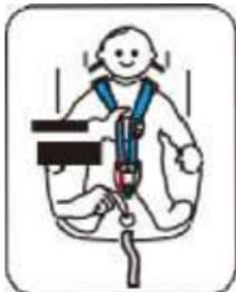
Schritt 1: die Gurte werden durch Drücken des Hebels (unter dem Deckel des Sitzes) auf die vordere Seite des Sitzes aufgelockert
