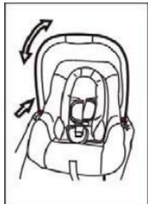
Manerul scaunului poate fi ajustat în 4 pozitii fixe. Pentru reglaj apăsați butonul roșu de pe ambele parti ale manerului.
