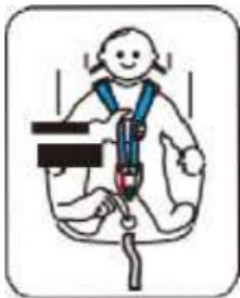
Paso 1: puede aflojar las correas empujando la palanca (que se encuentra por debajo de la cubierta de la silla) de la parte frontal de la silla
